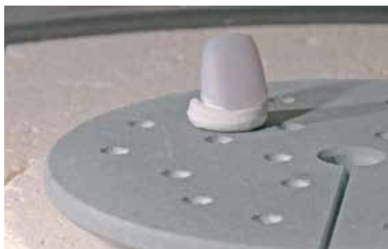
Brennuträger im Ofen platzieren und die Kristallisation durchführen.
