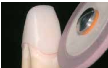
Randbereiche kontrollieren und ggf. leicht überarbeiten.
