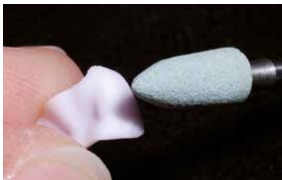
Mit geeigneten Schleifinstrumenten die Aussenflächen ...
