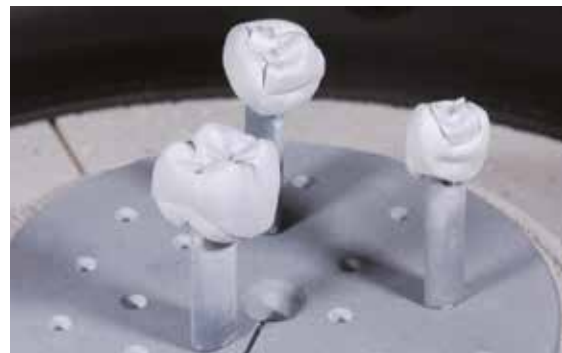
Restauration auf dem IPS e.max CAD Crystallization Tray im Ofen platzieren und mit den angegebenen Parametern brennen.
